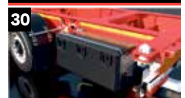
30 Werkzeugkasten aus PVC-beschichtetem Stahl
