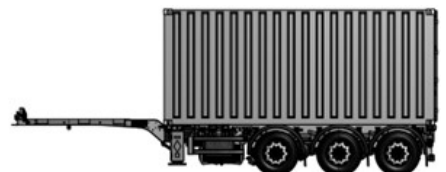
Beförderung eines 20-Fuß-Containers am Heck
