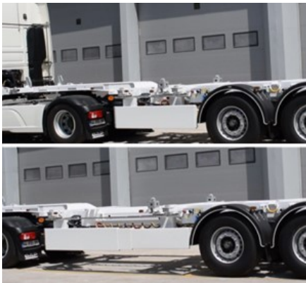
Ausfahren des Aufliegers mit Hilfe einer Zugmaschine
