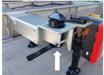
Anheben der Containersperre
