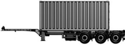
Beförderung eines 20-Fuß-Containers in der Mitte
