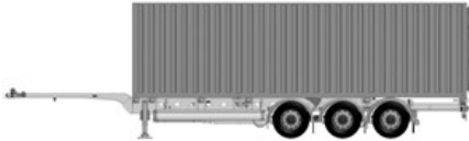
Transport eines 30-Fuß-Containers
