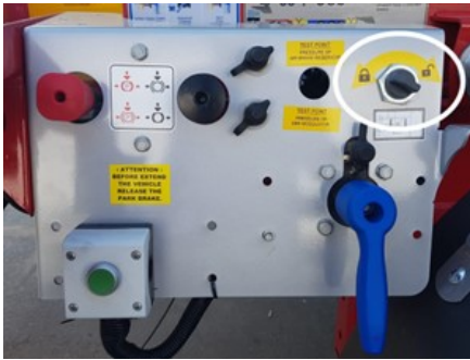
Position der Verriegelung des Mittelauszugs
