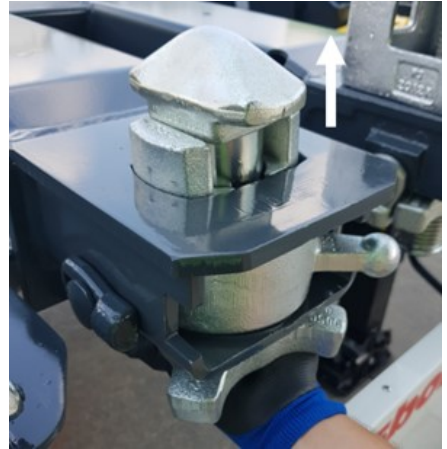
Abnehmen der Spannmutter
