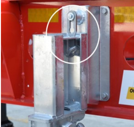
Einsetzen des Sicherungsstifts für den Stauraum
