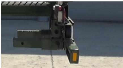
Geschlossene Version des verlängerten Stoßfängers
