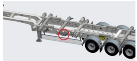
Lage des Verriegelungskeil-Lagerschranks
