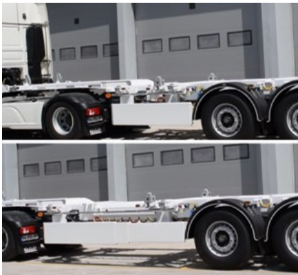
Verlängerung des Aufliegers mit Hilfe einer Zugmaschine
