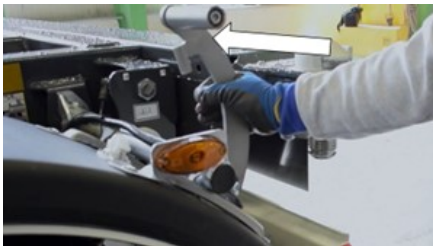
Schieben des Verlängerungshebels
