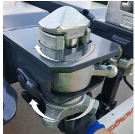
Rückführung in die Ladeposition
