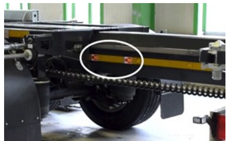
Kennzeichnung des Containertyps auf der Plattform
