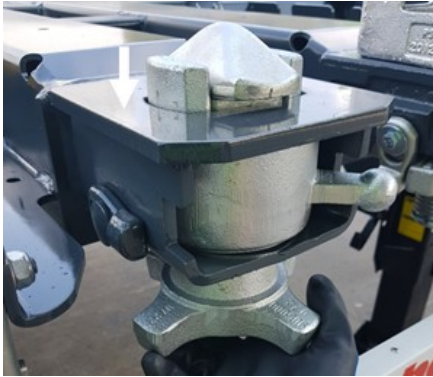
Absenken der Spannmutter
