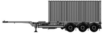
Transport von 20-Fuß-Containern vom Heck aus
