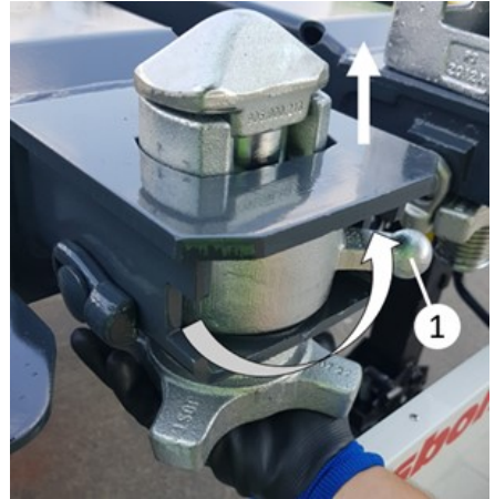
Entfernen der Spannmutter
