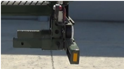
Geschlossene Version der verlängerten Stoßstange
