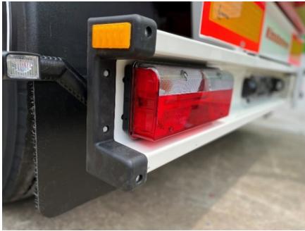
Typ C Unterfahrerschutz
