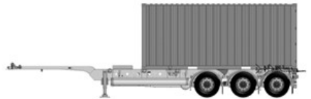
Beförderung eines 20-Fuß-Containers am Heck
