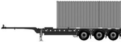
Beförderung von 20-Fuß-Containern im hinteren Bereich
