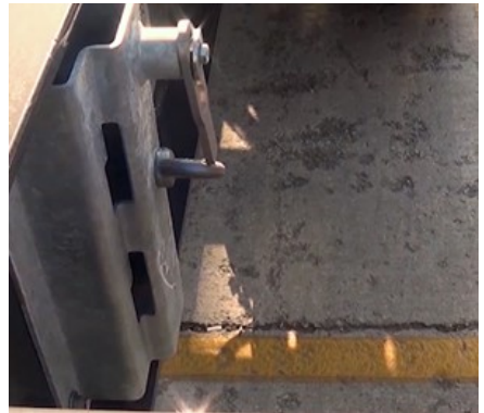
Aufbewahrungsschlitz des Containerschlosses
