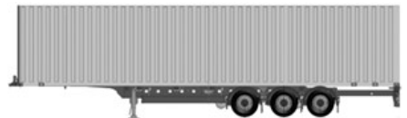
Transport eines 45-Fuß-LT-Containers
