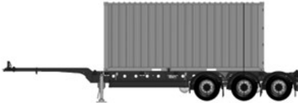
Beförderung von 20-Fuß-Containern in der Mitte
