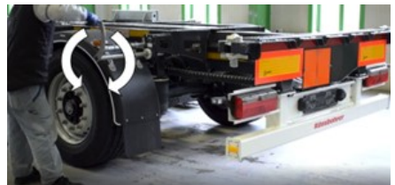
Einstellen der Länge der Plattform
