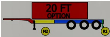
Transport von 20-Fuß-Containern in der Mitte
