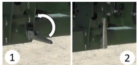
Verriegeln der verlängerten Stoßstange
