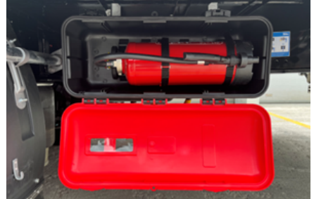
Öffnen des Feuerlöscherkastens
