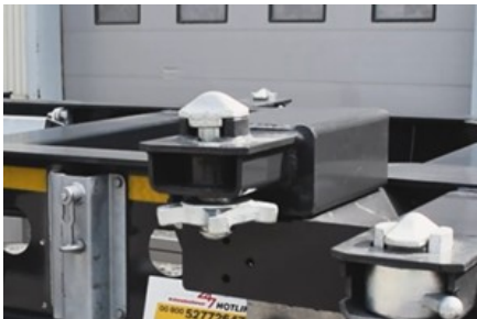
Anbringen des Schlosses an der oberen Fläche
