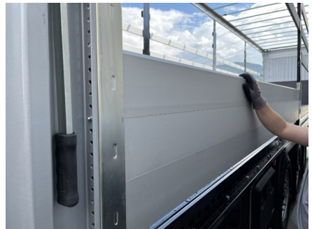
Überlappende Aluminium-Seitenstruktur vom Typ V
