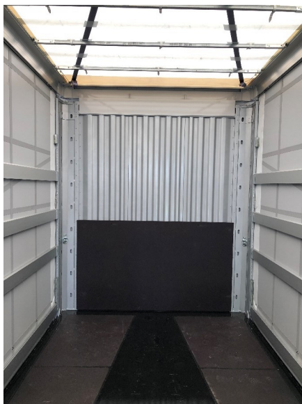
Sperrholzkonstruktion zum Schutz vor Stößen
