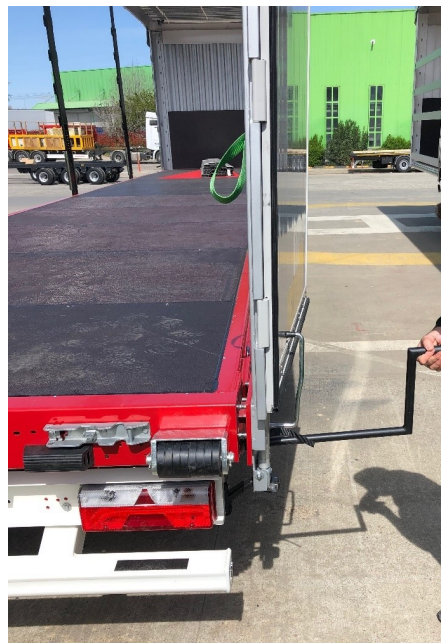
Mechanismus zum Öffnen der hinteren Säule
