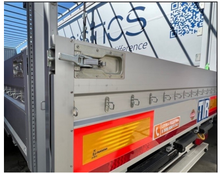
Verriegelungshebel und Sicherheitsklinke
