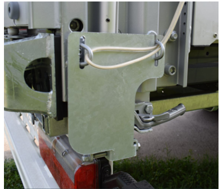
Öffnungen an der Zollabdeckung
