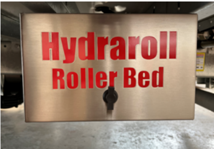
Bedienfeld für das Hebesystem des Schiebebodens
