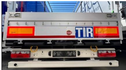
Verriegelungshebel und Sicherheitsklinke
