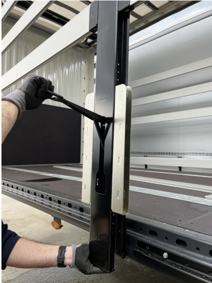
Öffnen des Schiebesäulenschlosses
