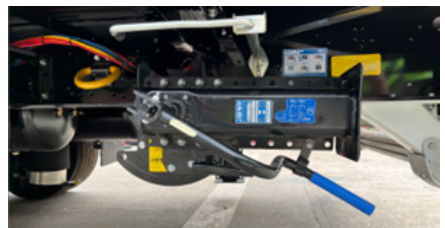
Klappbare hintere Absattelstütze
