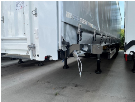
Vordere Spannung in geöffnetem Zustand
