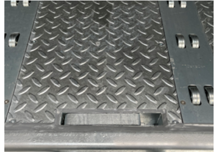
Palettenstopper in geschlossener Position
