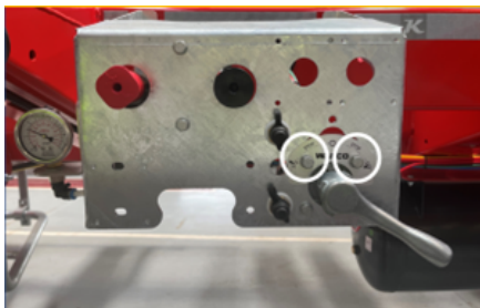
Stabilisierung der Federungshöhe
