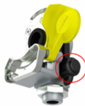
Palmkupplung mit Prüfpunkt
