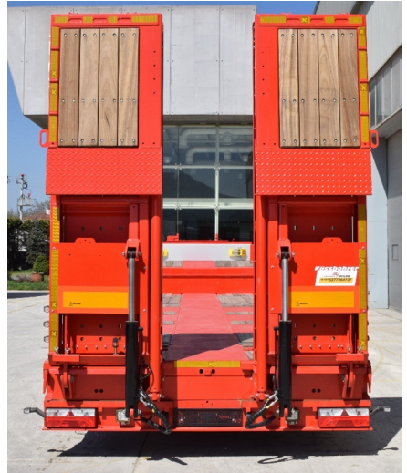
Rampe mit Hartholzboden
