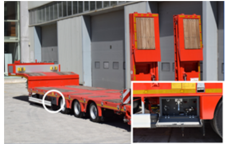
Lage des Steuerschranks am Tieflader
