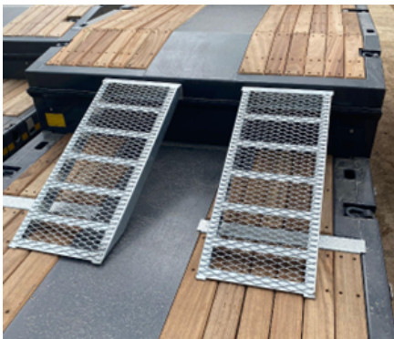
Tragbare Rampen aus verzinktem Stahl
