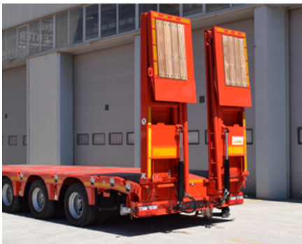
Angehobener Zustand der hydraulischen Rampe
