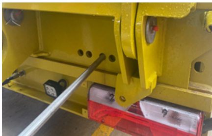
Verschieben der mechanischen Rampe mit Hilfe eines Brecheisens
