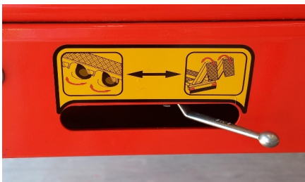
Position des Hydraulikventilhebels in der Rampe
