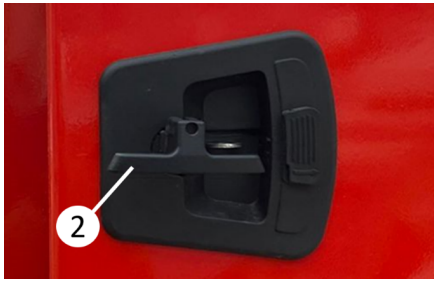
Herausnehmen und Drehen des Riegels
