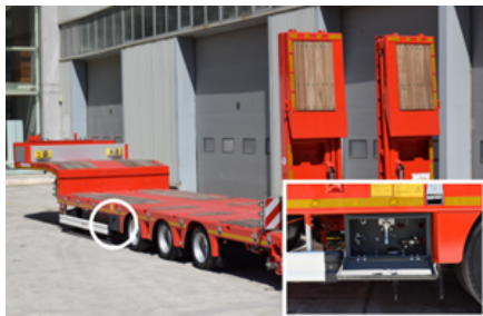
Standort des Schaltschranks im Tiefladerfahrzeug
