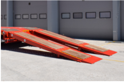
Abgesenkter Zustand der hydraulischen Rampe
