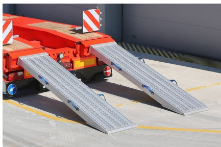
Rampen im Stoßfängerbereich
