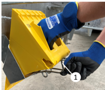
Herausnehmen des Keils aus dem Schlitz
