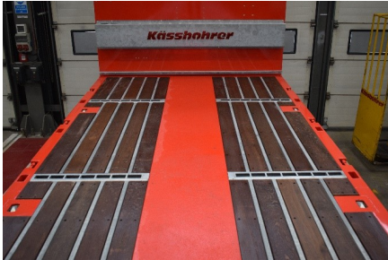
Omega verstärkter Holzboden
