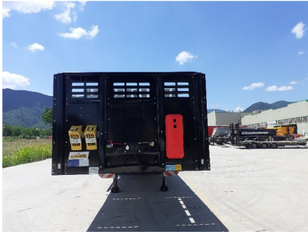
Feuerlöscherschrank an der Frontplatte
