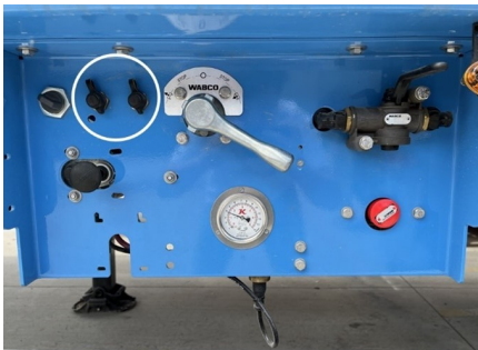
Achsanhebung-Piltaste im Schaltschrank
