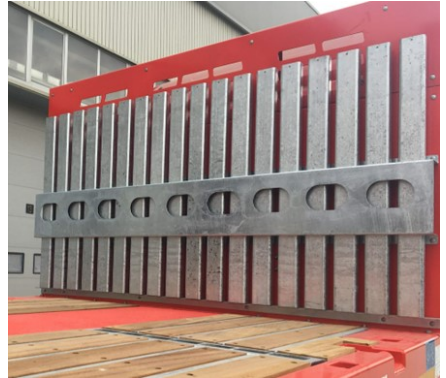
Lagerung der Rungen an der Stirnwand
