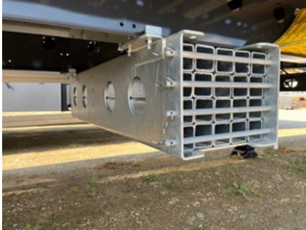
Rungenaufbewahrung unter dem Chassis
