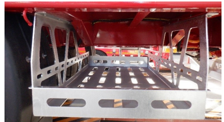
Lagerung der Rampe
