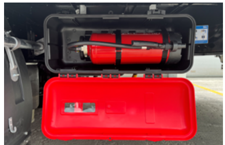
Öffnen des Feuerlöscherschranks
