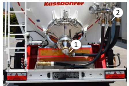
Fluidisierungsluftleitung und Ventil
