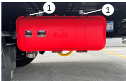
Otwieranie szafy na gaśnice
