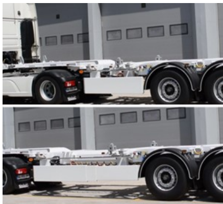
Rozsuwanie przyczepy z pomocą ciągnika
