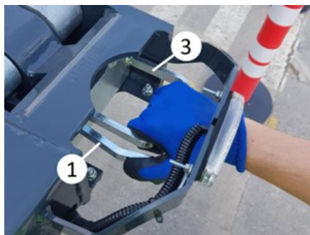
Nacisnąć zatrzask blokujący i pociągnąć dźwignię
