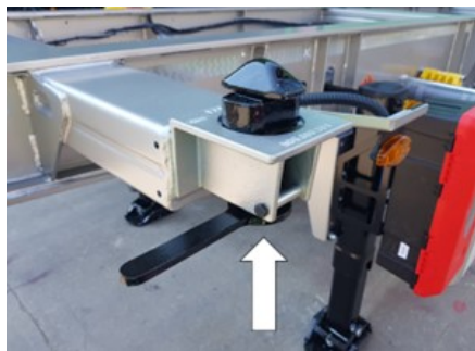
Podniesienie zamka kontenera
