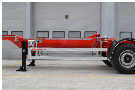
Standardowe zabezpieczenia przed wjechaniem pod tył pojazdu
