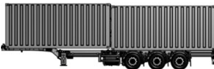
Transport kontenera 2x20 stóp
