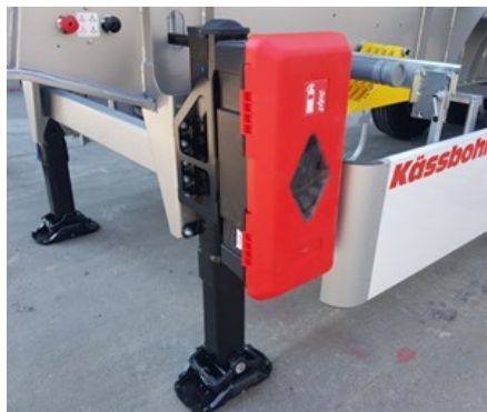
Szafka na gaśnicę
