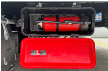
Otwieranie szafy na gaśnice
