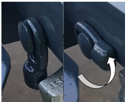
Obrócenie śruby zabezpieczającej o 90
