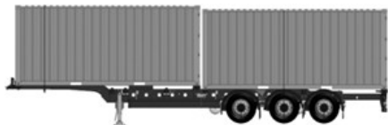
Transport kontenerów 2x20 ft
