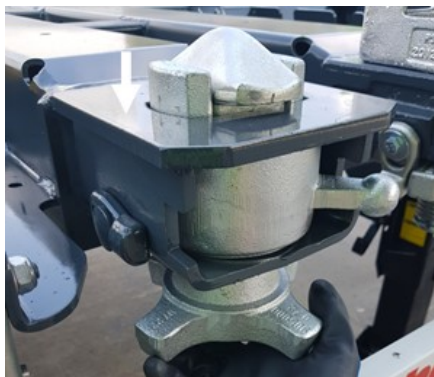
Opuszczanie nakrętki napinającej
