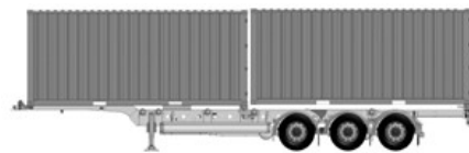
Transport kontenera 2x20 stóp
