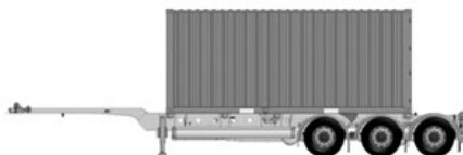
Transport kontenera 20 stóp pośrodku
