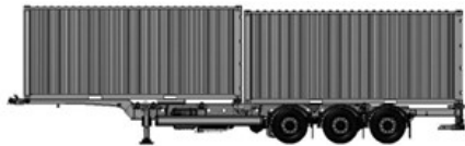
Transport kontenera 2x20 stóp
