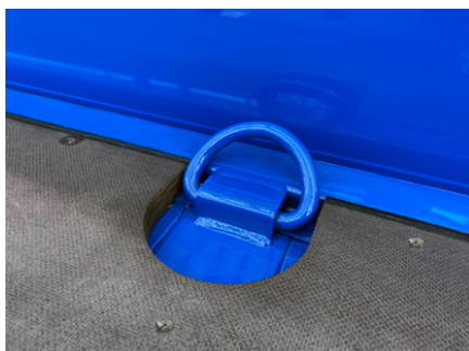
Mocowanie ładunku osadzone w podstawie
