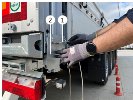
Demontaż liny celnej
