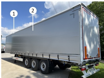
Konstrukcja kurtyny bez pokrycia celnego
