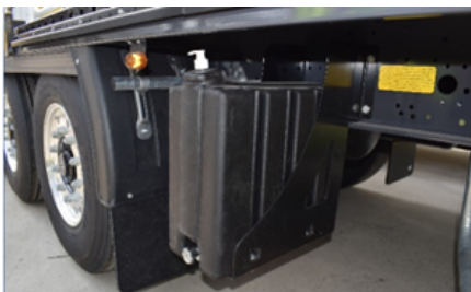
Plastikowy zbiornik na wodę
