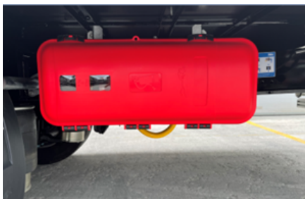
Szafa na gaśnice
