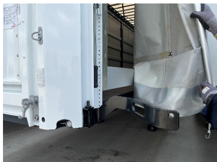
Demontaż rury kurtyny
