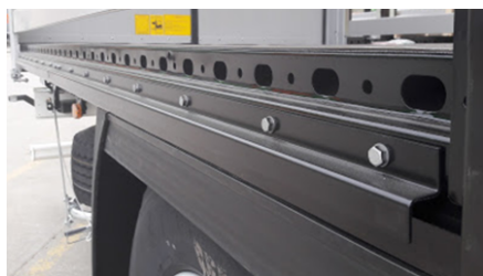
Metalowa bariera do wózka widłowego
