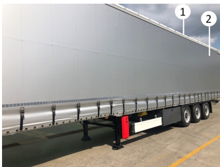
Konstrukcja kurtyny bez osłony celnej
