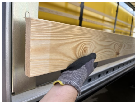
Drewniana konstrukcja boczna
