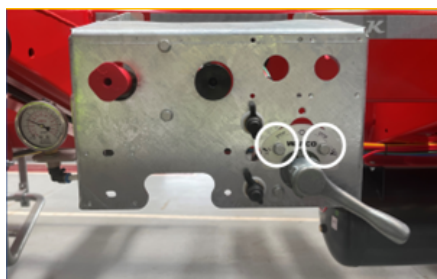
Ustalenie wysokości zawieszenia
