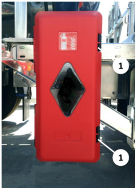
Szafka na gaśnice
