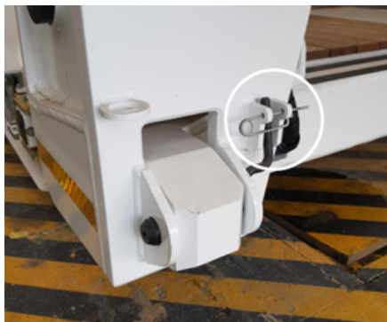
Wkładanie zawlecзки zabezpieczającej
