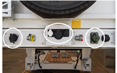
Elektrik bağlantılarının konumu
