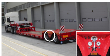
Pozycja zaworu opuszczania - podnoszenia na pojeździe niskopodwoziowym
