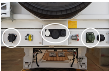
Wykonaj połączenia elektryczne.
