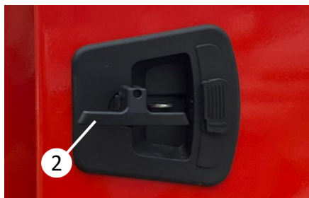
Zdejmowanie i obracanie zatrzasku blokującego
