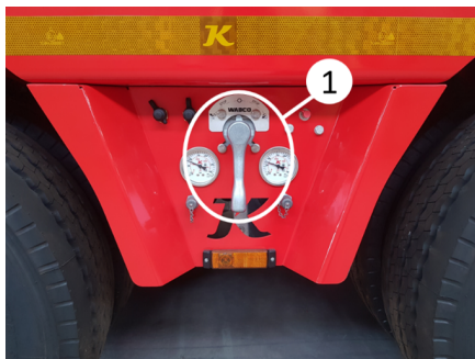
Pozycja jazdy z zawieszeniem pneumatycznym ze sterowaniem ręcznym
