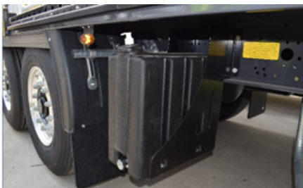
Plastikowy zbiornik na wodę
