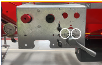
Ustalenie wysokości zawieszenia
