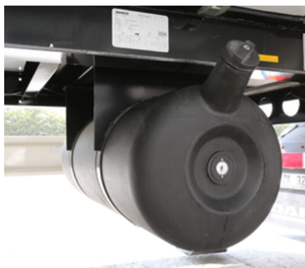
Zbiornik na olej napędowy z tworzywa sztucznego
