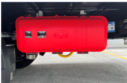
Szafa na gaśnice
