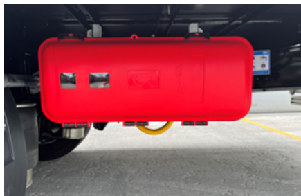
Szafa na gaśnice
