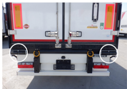
Kliny do odpoczynku na rampie
