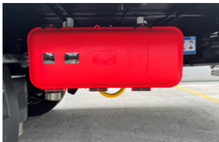
Szafa na gaśnice
