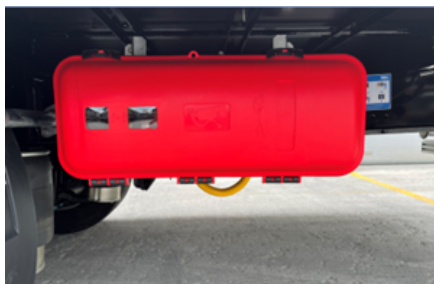
Szafa na gaśnice
