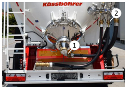
Linia powietrza fluidyzacyjnego i zawór
