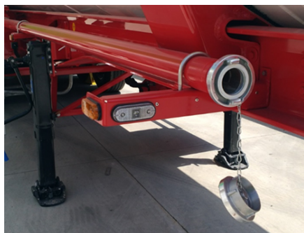
Przewód powietrza fluidyzującego
