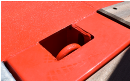
Zakopany pierścień zabezpieczający ładunek
