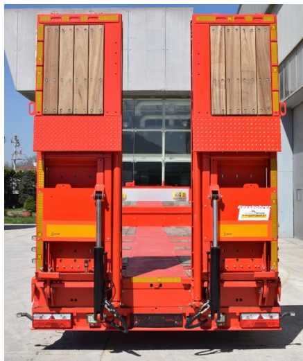
Rampa z twardego drewna
