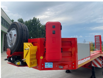
Szafka na gaśnice
