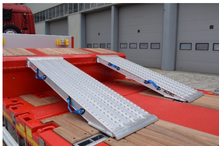
Aluminiowa rampa zastosowana w obszarze gęsiej szyi
