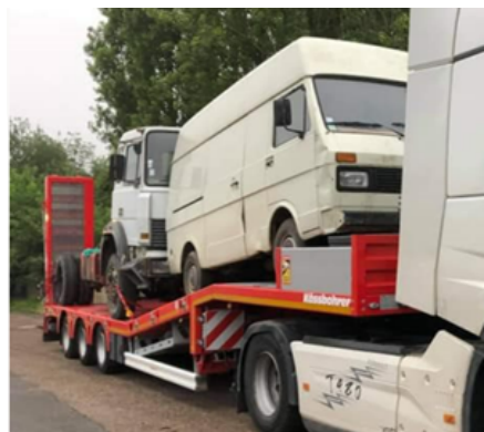
Zastosowanie hydraulicznej rampy na gęsiej szyi
