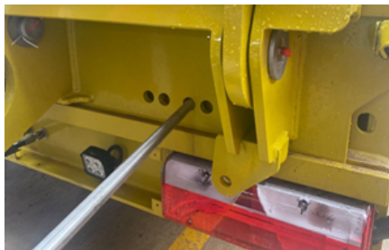
Przesuwanie rampy mechanicznej za pomocą łomu
