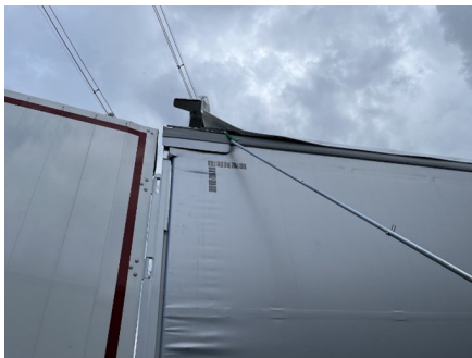
Przesuwanie dachu od zewnątrz
