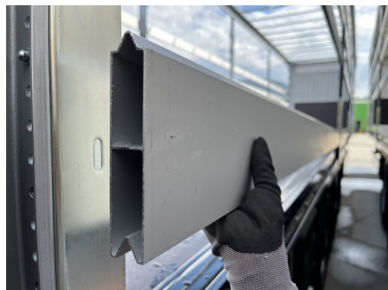
Aluminiowa struktura boczna typu V
