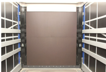
Konstrukcja ze sklejki dla ochrony przed uderzeniami
