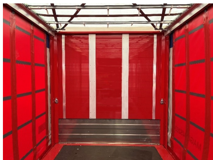
Aluminiowa płyta ochronna panelu przedniego
