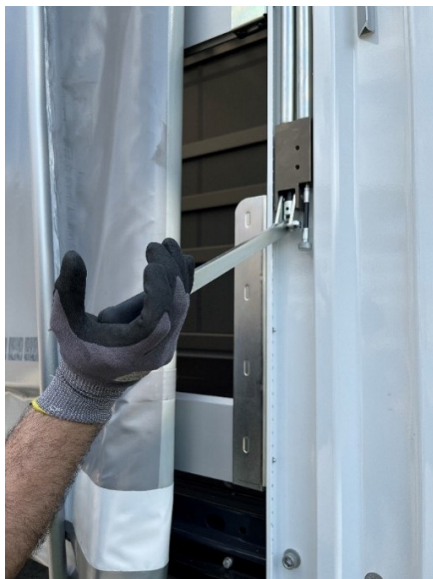
Ramię podnoszenia dachu
