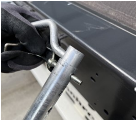
Sworzeń blokujący ciągnio dachu przesuwanego
