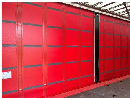
Pionowa kurtyna z listwami ze stali nierdzewnej
