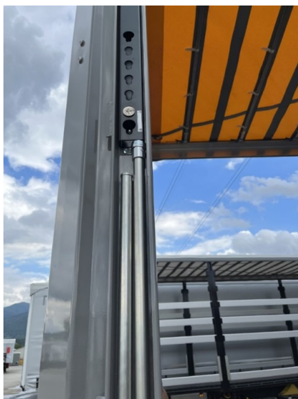
Belka poziomu podnoszenia dachu
