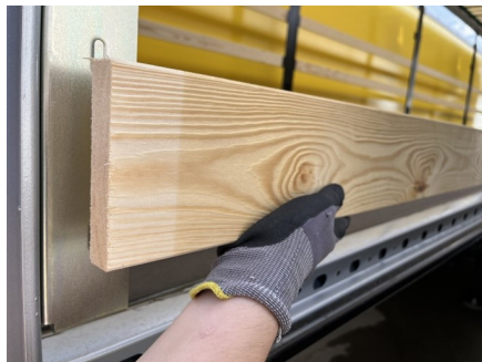
Drewniana konstrukcja boczna
