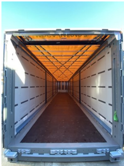
Podłoga ze sklejki powlekaney żywicą fenolową
