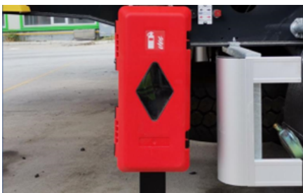
Szafka na gaśnice
