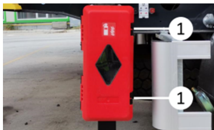
Otwieranie szafki na gaśnicę
